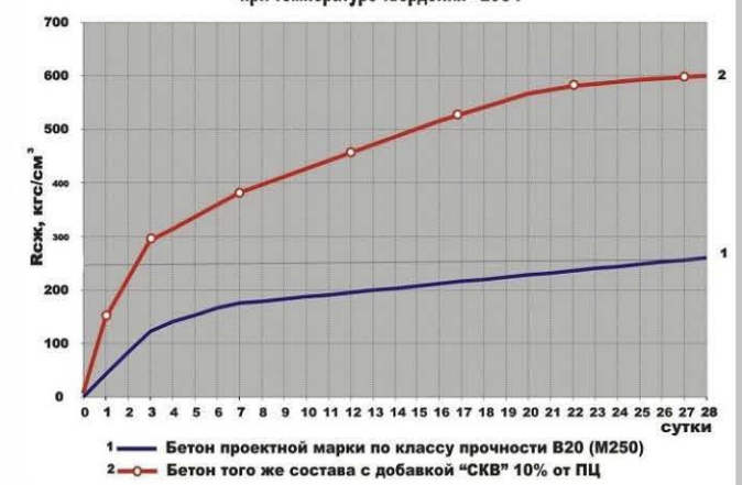
Рис.1 График набора прочности бетона с одинаковой подвижностью П2 при температуре твердения +20С.
